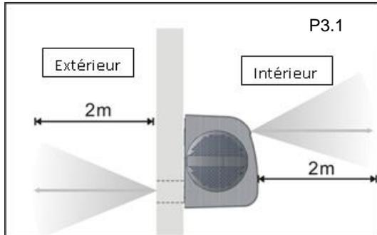
Le climatiseur doit être installé à l'intérieur d'une pièce, sur un pan de mur dont l'autre pan est en contact avec l'extérieur, et avec un minimum de 2 mètres de dégagement de part et d'autre.
