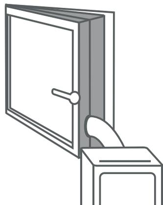
**8** Lorsque que vous n'utilisez plus le climatiseur, il vous suffit d'enlever le tuyau d'évacuation d'air chaud en ouvrant la fermeture éclair.
