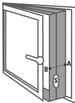
**7** Ouvrir la fermeture éclair de préférence aux endroits marqués d'un « S » et installer votre tuyau d'évacuation d'air chaud.
