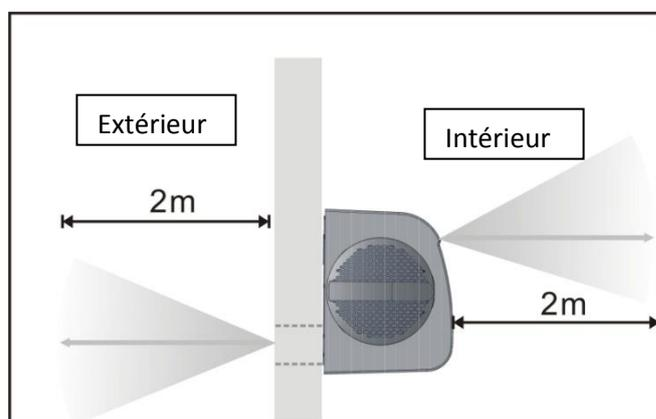
Après avoir déterminé le meilleur emplacement pour l'installation comme décrit ci-dessus, veuillez-vous assurer que le mur peut être percé dans la zone choisie sans interférer avec d'autres installations, structures ou réseaux (poutres, piliers, tuyaux, câbles, etc.).
