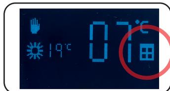
Lors de la fermeture de la fenêtre, le radiateur détectera une augmentation de la température et cette fonction sera désactivée.
